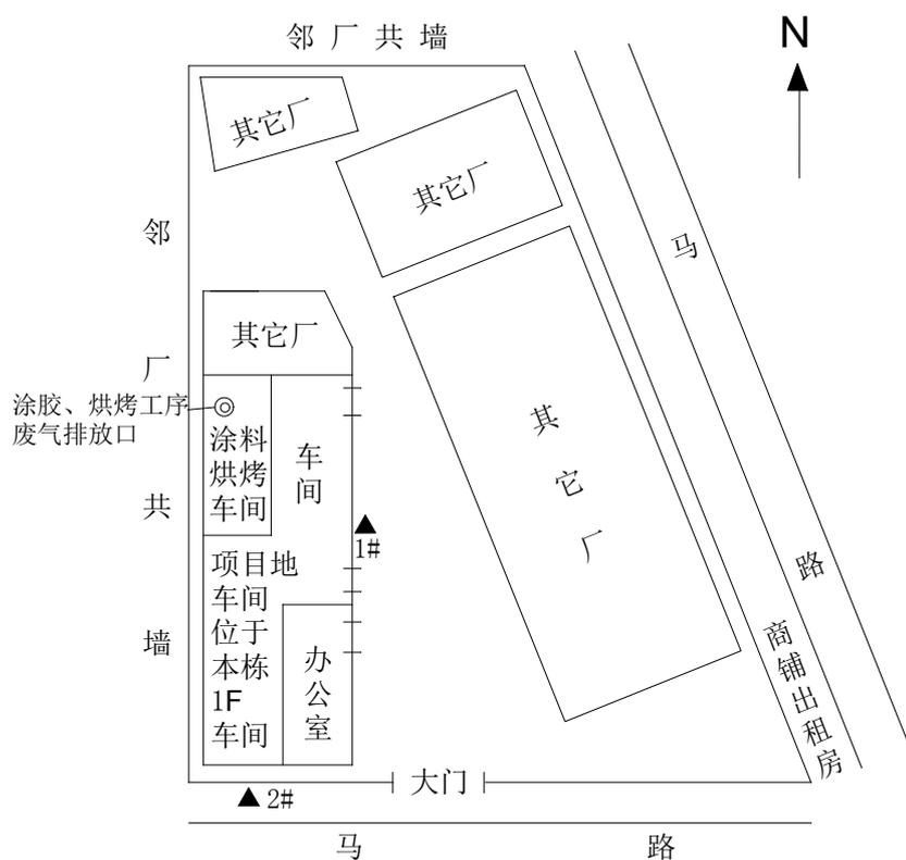
注：◎涂胶、烘烤工序废气排放口，▲噪声监测点
