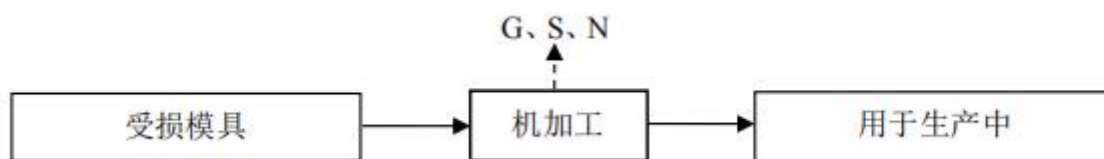
图 3-5 模具生产工艺及产污环节流程图
