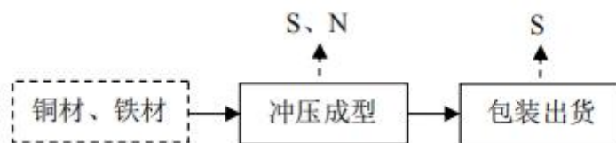
图 3-4 五金配件生产工艺及产污环节流程图
